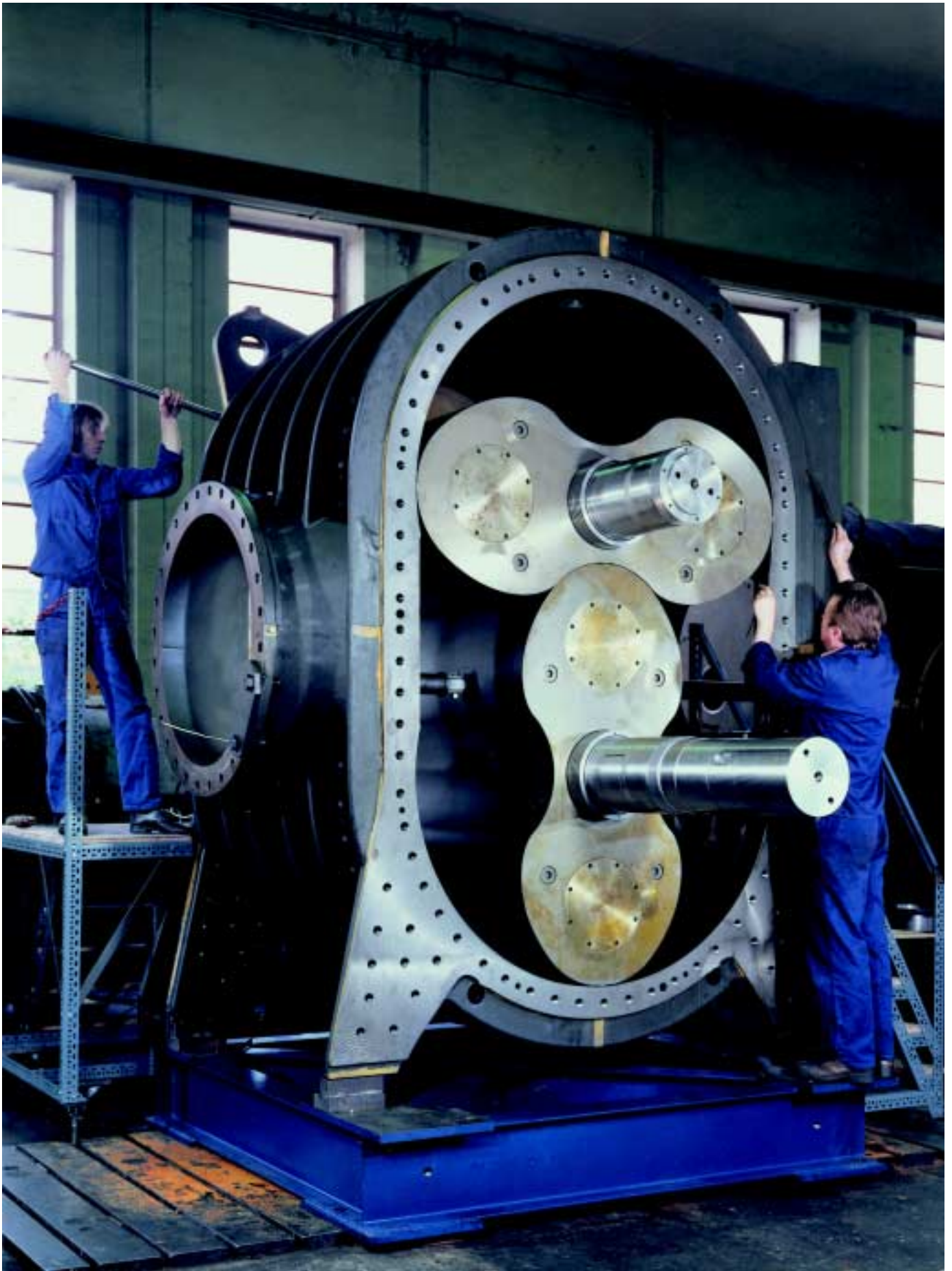
Uno de los soplantes de émbolos rotativos más grandes de Aerzen para transporte sin aceite y compresión de 65.000m 3 /h de proceso de gas en una presión de funcionamiento de 900 mbar, en una planta de acero. Largo 3.750 mm, ancho 2.400 mm, altura 3.000 mm, peso 27,2 t.
